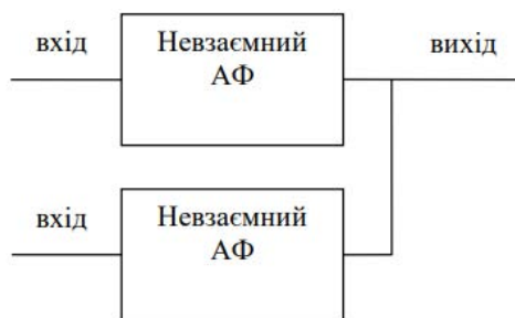
Рис. 8. Блок схема НВЧ – комутатора на два канали
